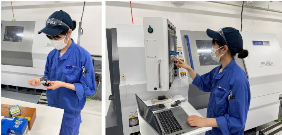
左：製品の形状測定作業の様子 右：NCプログラム(工作機械を動かすためのプログラム)の変更を行っている様子
